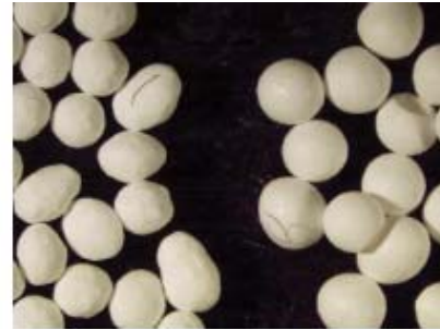
图3 暴露在pH值1.2HCl盐缓冲液前(左边小丸)/后(右边小丸)的小丸光学显微镜照片。其中，(A) 不含气相二氧化硅，(B) 喷有1.0%增重气相二氧化硅
