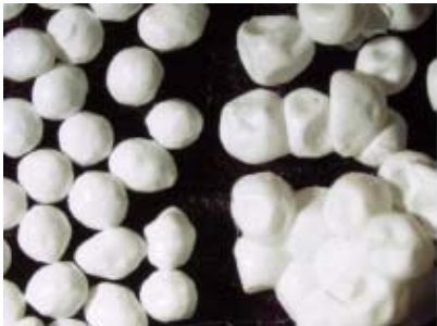
图4 暴露在 pH 4.5 的醋酸缓冲液前(左边小丸)/后(右边小丸)的小丸的光学显微镜照片。其中，(A) 不含气相二氧化硅，(B) 喷有 1.0%增重的气相二氧化硅 含有或不含气相二氧化硅的包衣小丸
