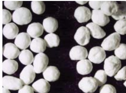
图4 暴露在 pH 4.5 的醋酸缓冲液前(左边小丸)/后(右边小丸)的小丸的光学显微镜照片。其中，(A) 不含气相二氧化硅，(B) 喷有 1.0%增重的气相二氧化硅 含有或不含气相二氧化硅的包衣小丸
