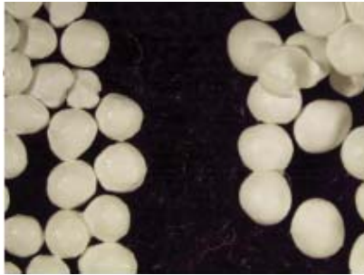
图3 暴露在pH值1.2HCl盐缓冲液前(左边小丸)/后(右边小丸)的小丸光学显微镜照片。其中，(A) 不含气相二氧化硅，(B) 喷有1.0%增重气相二氧化硅
