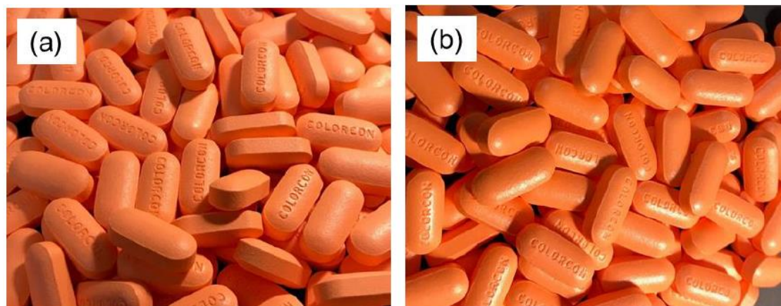
图 5: 空白片在 48”包衣锅中, 先用(a)彩色欧巴代 EZ 包衣, 再外加(b)透明型欧巴代 EZ 包衣
