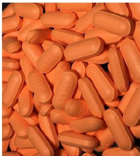
图 4: 固含量 18%时欧巴代 EZ 彩色包衣的扑热息痛片
