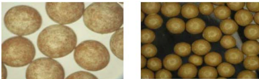
图 3. 高载药量剂型：18 个月后，在室内温度&湿度下，PVC 容器中自由流动的微丸
