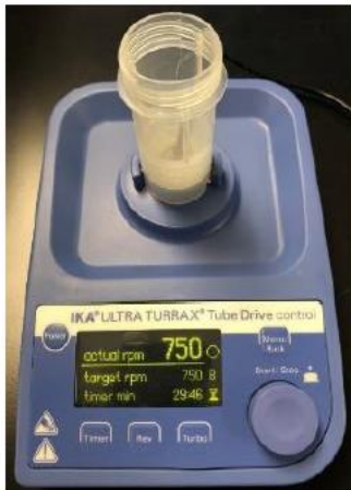
图 1. 配备 20mL 混合容器的 IKA ULTRA- TURRAX Tube Drive 试管分散系统
