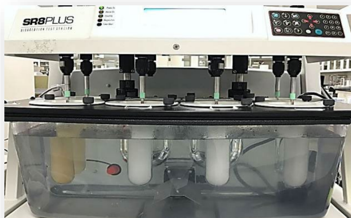
图 1. 用于高通量筛选的小体积溶出装置
