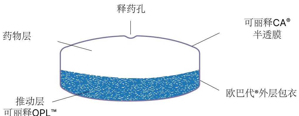
结合可丽释OPL一起使用，可丽释OPL是专为双层的推拉式渗透泵片直接压片生产而设计的直压型推动层预混辅料。
