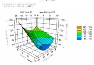
根据采用的工艺条件,必须调整空气流量,维持稳定的流化模式。
