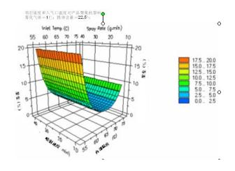
低雾化压力、高固含量均为聚集的主要原因。雾化压力低、固含量高时产品聚集最严重。这可能是由于低的空气和液体比例以及较高粘度导致的分散液滴较大。
