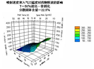
如上所述,所有工艺条件显示的影响药物释放的因素中,固含量和喷液速率影响最大用高喷液速率和低固含量导致较快的药物释放。这很可能是由于包衣过程中药物迁移所致。
