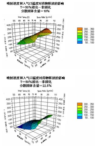
如上所述,所有工艺条件显示的影响药物释放的因素中,固含量和喷液速率影响最大用高喷液速率和低固含量导致较快的药物释放。这很可能是由于包衣过程中药物迁移所致。
