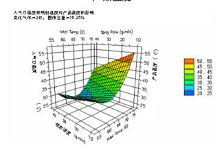
产品温度的范围为 28°C – 59°C。进风温度和包衣喷液速率对产品温度的影响最大。毫不意外的是,进风温度的升高会导致物料床温度增加。该响应在包衣喷液速率较低时最强。
