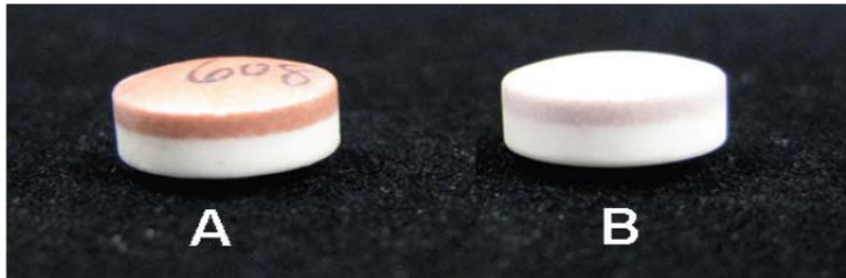
图 4. 可接受的透明度(A 实验 9)与不可接受的半透膜的不透明度(B, 来自于另外的实验)
